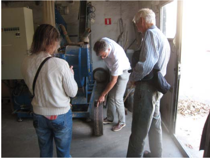
Sven-Olof visar en av matriserna till pilot-skala pelletspressen.
